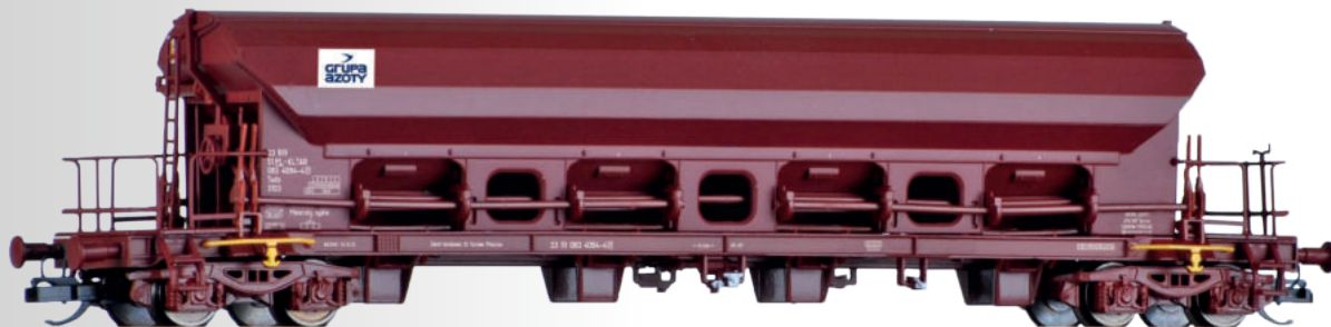
Schwenkdachwagen Tads der Grupa Azoty Koltar (PL) Swing roof car Tads of the Grupa Azoty Koltar (PL)
