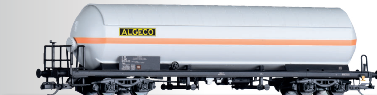
Gaskesselwagen Uahs der SNCF Gas tank car Uahs of the SNCF • Mit Sonnenschutzdach / With sunshield
