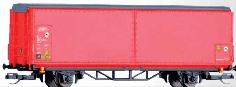
Schiebewandwagen Hbis-tt 293 der DB AG Sliding wall box car Hbis-tt 293 of the DB AG
