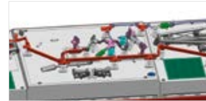
Vorbildgerechter Dachgarten mit Dachleitung sowie Dachtrenner
