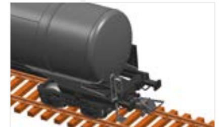
Freistehende Griffstangen und Rangiertritt
